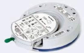
Les électrodes et la batterie du Samaritan PAD sont emballées dans une cassette : le PadPak. Il s'installe et se remplace d'un simple geste. Pas de soucis avec des électrodes et une batterie séparée, tout a été pensé pour faciliter son entretien : un seul consommable doit être remplacé tous les 4 ans (4 ans d'autonomie). Le Samaritan PAD est également l'un des DAE le moins cher à utiliser en termes de coûts de consommables.
